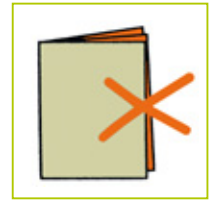
Einlage nicht bündig eingeklebt
