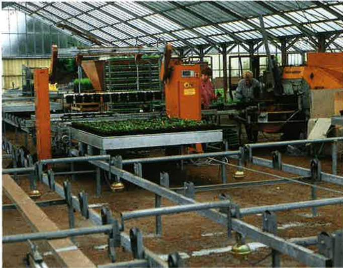
Hochleistungstopfanlage mit Absetzroboter und Mobiltischsystem für die Massenproduktion.
